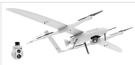
Рис. 2. БВС типа VTOL, оснащенный гиросtabilизированной камерой наблюдения
